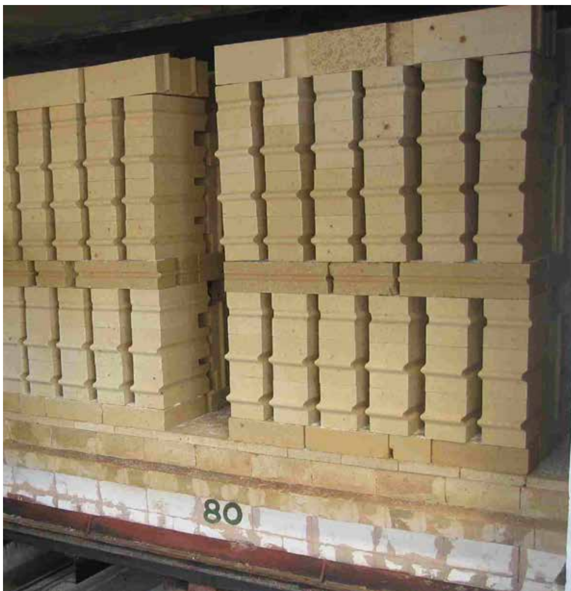
Kiln for silica bricks Ofen für Silika-Steine 生产硅砖的窑炉
